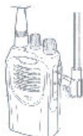
หากไม่ได้ใช้อุปกรณ์ภายนอกเพิ่มเติม (Speaker-Microphone) ควรทำการใส่แผ่นกันฝุ่นเพื่อป้องกันมิให้ฝุ่นละอองเข้าไปในตัวเครื่อง
