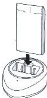
2. การชาร์จแบตเตอรี่แบบแพ็คหรือแบบเฉพาะก้อนนำแบตเตอรี่แพ็ค วางลงในที่ชาร์จให้ถูกต้องเพื่อทำการชาร์จ
